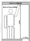
**INSTALLATION HORS D'ATTEINTE DES PARTIES CHAUDES DU LUMINAIRE**: Le luminaire peut seulement être installé en dehors de la zone d'accessibilité au toucher afin d'éviter tout risque de brûlure lors de la manipulation.
