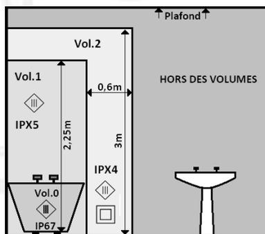
Les luminaires installés dans les lieux humides comme la salle de bain doivent respecter les critères de la norme NFC15-100. Ces luminaires doivent comporter un indice de protection (IPxx) et être installés uniquement dans le volume pour lequel ils sont autorisés. La salle de bain est répartie en 3 volumes.
