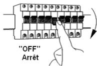
1. Avant toutes opérations d'installations, de connexions, de remplacement d'ampoules ou de nettoyage du luminaire, il est impératif de couper l'alimentation du courant sur le tableau électrique
